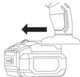
Aby odłączyć akumulator, naciśnij przycisk zwalnający akumulator (10) i przesuń podstawę wiertarki, aż zostanie całkowicie odłączona:
