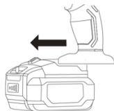
Om de batterij los te koppelen, drukt u op de batterijontgrendelingsknop (10) en schuift u de basis van de boor totdat deze volledig is losgekoppeld:
